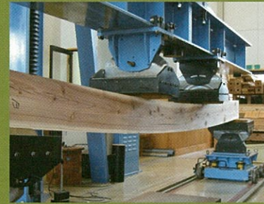
スギ平角の曲げ強度試験
