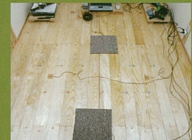
クロマツフローリングの床暖房評価試験
